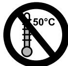
Einsatz und Lagerung des Akkumulators nur im Temperaturbereich von - 10 °C bis max. + 50 °C.
