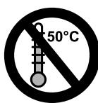
Gebruik en opslag van de accu's alleen bij temperaturen van -10 °C tot max. +50 °C.
