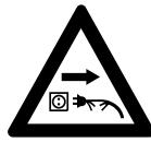
De netkabel van de acculader regelmatig op beschadigingen controleren. Bij beschadiging van de netkabel direct de netsteker uit de contactdoos trekken – **levensgevaar door elektrische schokken!**
