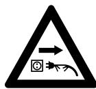
Contrôler régulièrement si le cordon d'alimentation du chargeur n'est pas endommagé. En cas d'endommagement du cordon d'alimentation électrique, retirer immédiatement la fiche de la prise de courant – **danger de mort par électrocution !**
