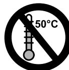
Utiliser et ranger la batterie exclusivement dans la plage de températures de - 10 °C à max. + 50 °C.
