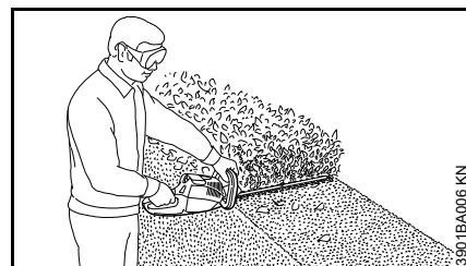
Bei breiten Hecken in mehreren Arbeitsgängen vorgehen.
